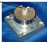
Schweinekiefersegment mit insertertem Implantat.
