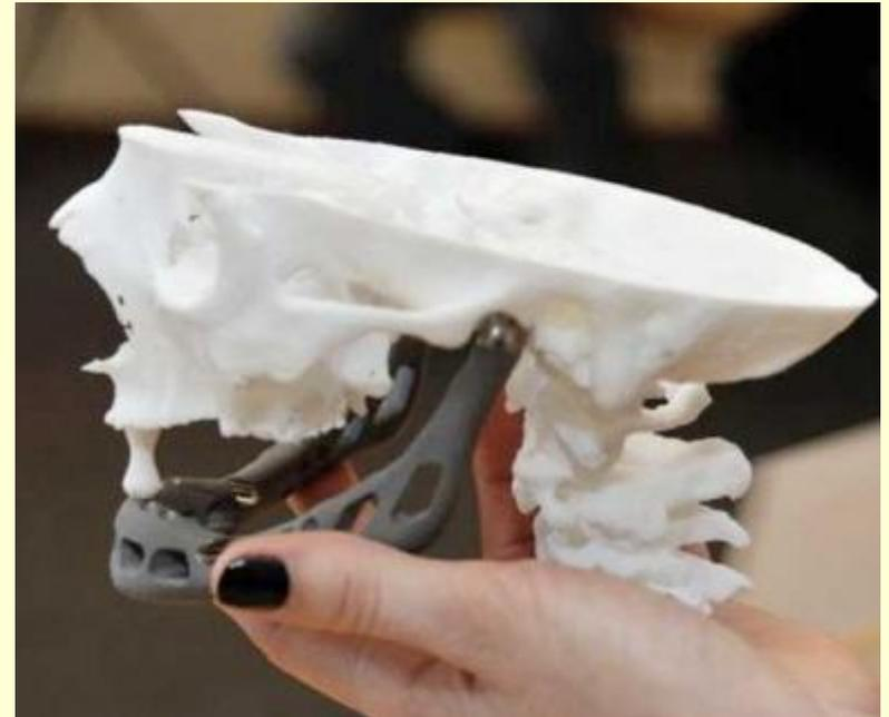
Unterkieferimplantat aus Titan hergestellt durch einen 3D-Drucker. Links mit aufgesetzter Zahnprothese, rechts eingepasst in einen mit Rapid-Prototyping Techniken hergestellten Schädel.
