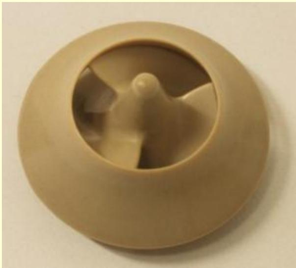
LaufRad einer Diagonalpumpe aus PEEK (d=24mm)
